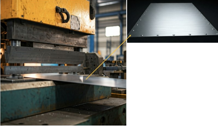
Şekil 1: Şekillendirmeye hazırlanan sac metal levha.
